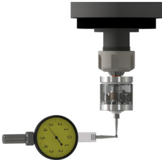
Ось шпинделя перемещается вручную, а амплитуда отклонения датчика записывается с помощью индикатора.
