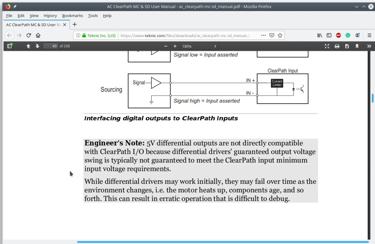
По сути, плата преобразователя необходима для создания постоянного сигнала 5В, который драйвер ClearPath сможет принять. Эти преобразователи линейного драйвера в 5V доступны в составе некоторых комплектов [myCNC Online Shop](#).
